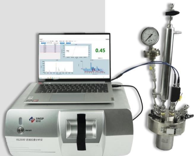
鉴知®RS2000在线拉曼分析仪可用于反应过程**原位、实时、连续在线监测**。
